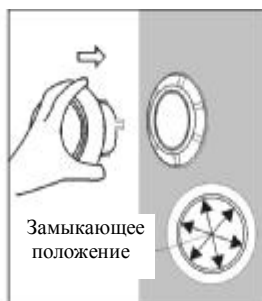
Установка диффузора в корпус. Одна из насечек на диффузоре должна быть направлена в середину места фиксации
