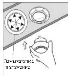
Установка диффузора в корпус. Одна насечка должна быть направлена в середину места фиксации.
